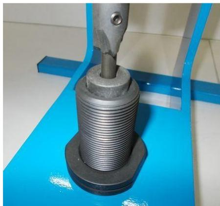
3. Для регулировки соосности необходимо совместить пуансон и опорную втулку, следующим образом: подвести пуансон к опорной втулке, при этом ослабить гайку ее крепления, совместить пуансон и затянуть гайку. После чего проверить надежность закрепления цилиндра и опорной втулки.
