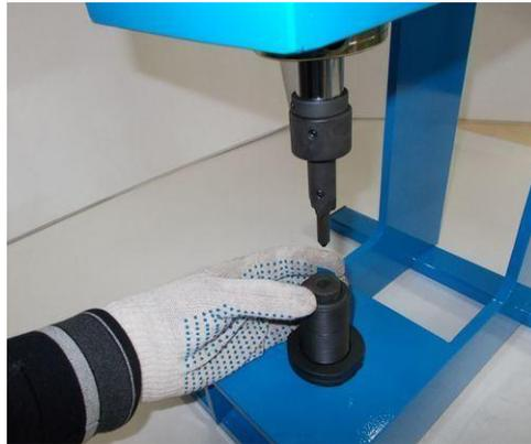
2. Используя пневмогидравлический насос станда, опустите гидравлический шток вниз и проверьте соосность пуансона и втулки друг относительно друга (см. рис. 2).
